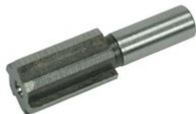
Le conversioni Wildcat utilizzando il proiettile da .224" con un diametro interno del collo di .2200" e il proiettile da .243" con un diametro interno del collo di .2390", Forster offre reamers per il collo interno per queste dimensioni. Utilizzare dopo l'operazione di dimensionamento del CASE.
